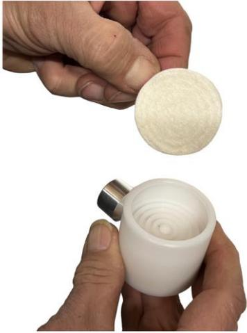
Luftfilterfilze durch Neue ersetzen
